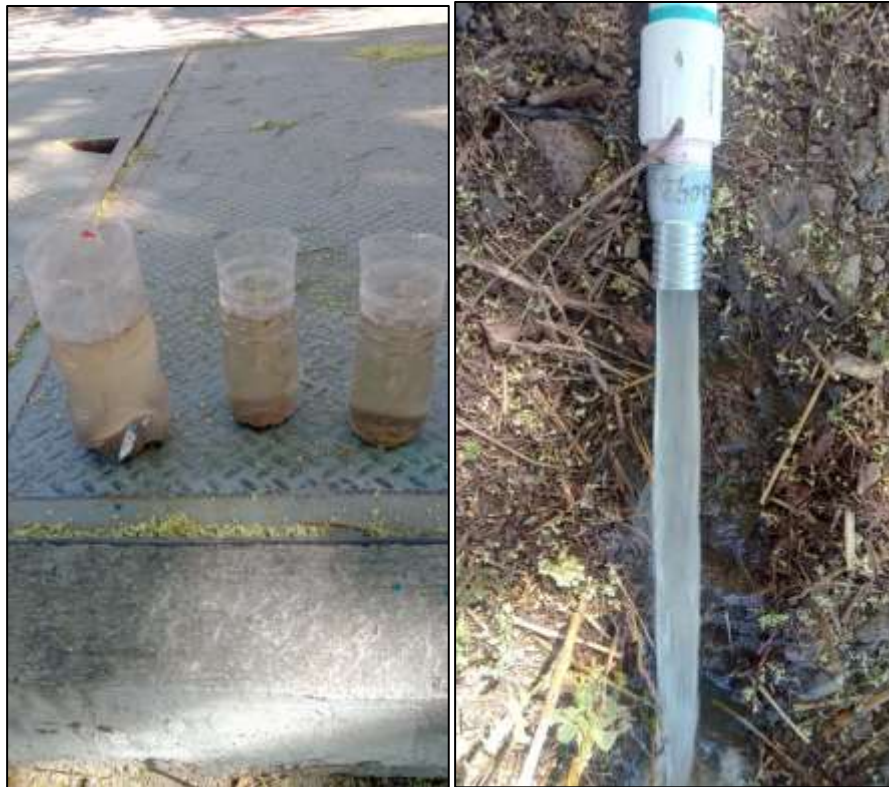
Figura 6.- Después del proceso de oxigenación y sedimentación en los biodigestores 2 y 3, se aprecia el cambio de la turbidez o concentración de sólidos disueltos.
