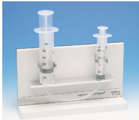
Figura de cómo puedes construir la prensa hidráulica
